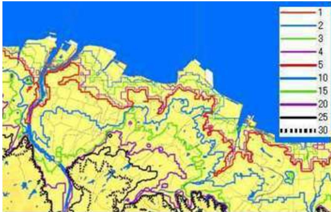
大分大学工学部津波浸水シミュレーション（標高；m）
